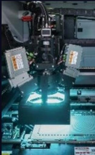
**AOI - Inspeção Óptica Automática**
